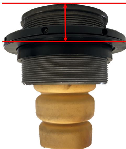
Abb. 5: HA Einstellmaß Fig. 5: RA adjustment dimension
